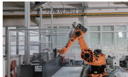
图1 KUKA机器人协同外部K600测量工具的加工制造
